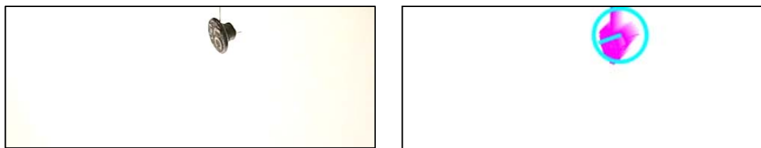
Rys. 14. Próbkę z przedmiotem znajdującym się wewnątrz butelki z płynem (a) oraz wynik działania algorytmu przepływu optycznego (b). Koło zakreśla wykryty obiekt, natomiast promień wychodzący ze środka pokazuje aktualną prędkość obiektu.
